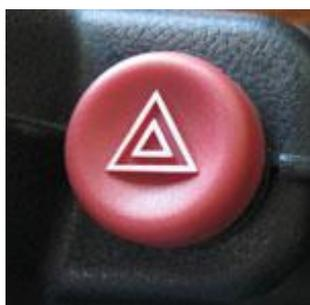
Абсолютно в каждом автомобиле есть такая клавиша (или кнопка) – если её нажать, то начинают одновременно мигать все указатели поворотов и ещё два повторителя на боковых поверхностях передних крыльев. То есть сразу мигают целых шесть лампочек оранжевого цвета со всех сторон автомобиля. Водитель, включая аварийную сигнализацию или применяя знак аварийной остановки, как бы кричит остальным участникам движения:
